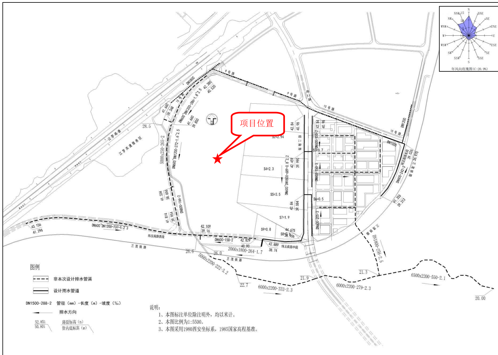
附图 12项目所在区域雨水管网图
