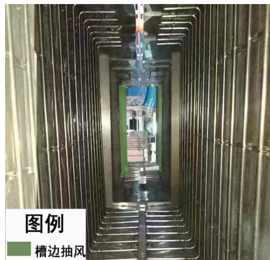
图 4-6 前处理清洗线废气收集参考示意图
