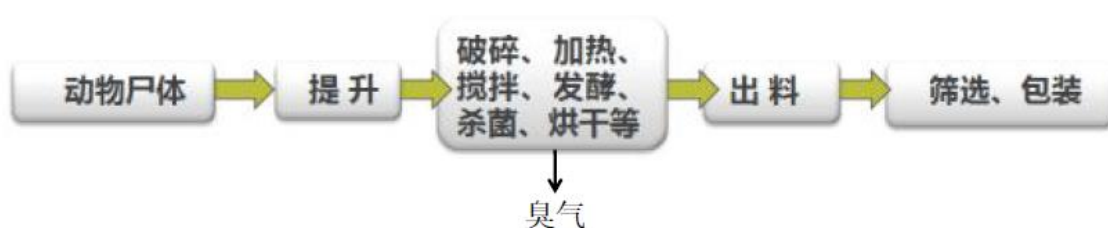
图 3.2-4 无害化降解机技术原理图
