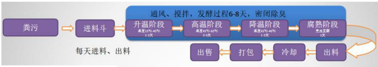
图 3.2-6 发酵罐工艺流程图
